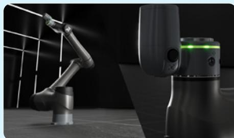
Redefinindo a robótica colaborativa com IA de última geração, a Techman Robot anunciou o lançamento do braço robótico TM30S. Este *cobot* de alta *performance* está preparado para revolucionar a indústria com uma capacidade máxima de carga de 35 kg e um alcance de 1702 mm, o TM30S oferece a melhor relação "alcance-carga", em comparação com outros *cobots* na categoria de 30 kg.
